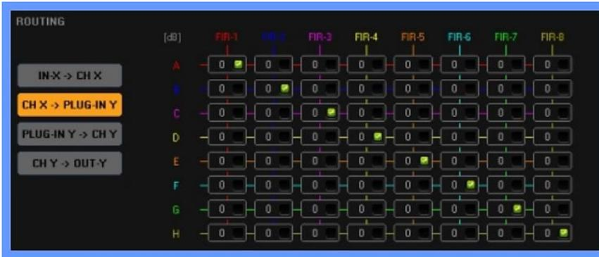
Подключаемый канал к выходному каналу обработки может быть отправлен в виде матрицы 8×8
