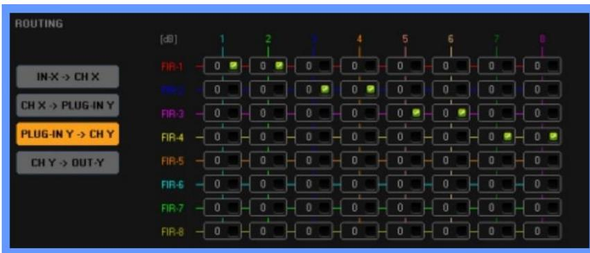
Канал обработки вывода на физический выходной канал может быть наложен на соседние каналы.
